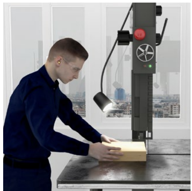
Abb. 18 B: Teilflächenbezogene Beleuchtung an einer Bandsäge
