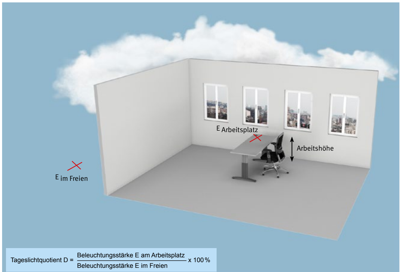
Abb. 5 Ermittlung des Tageslichtquotienten an einem Arbeitsplatz
