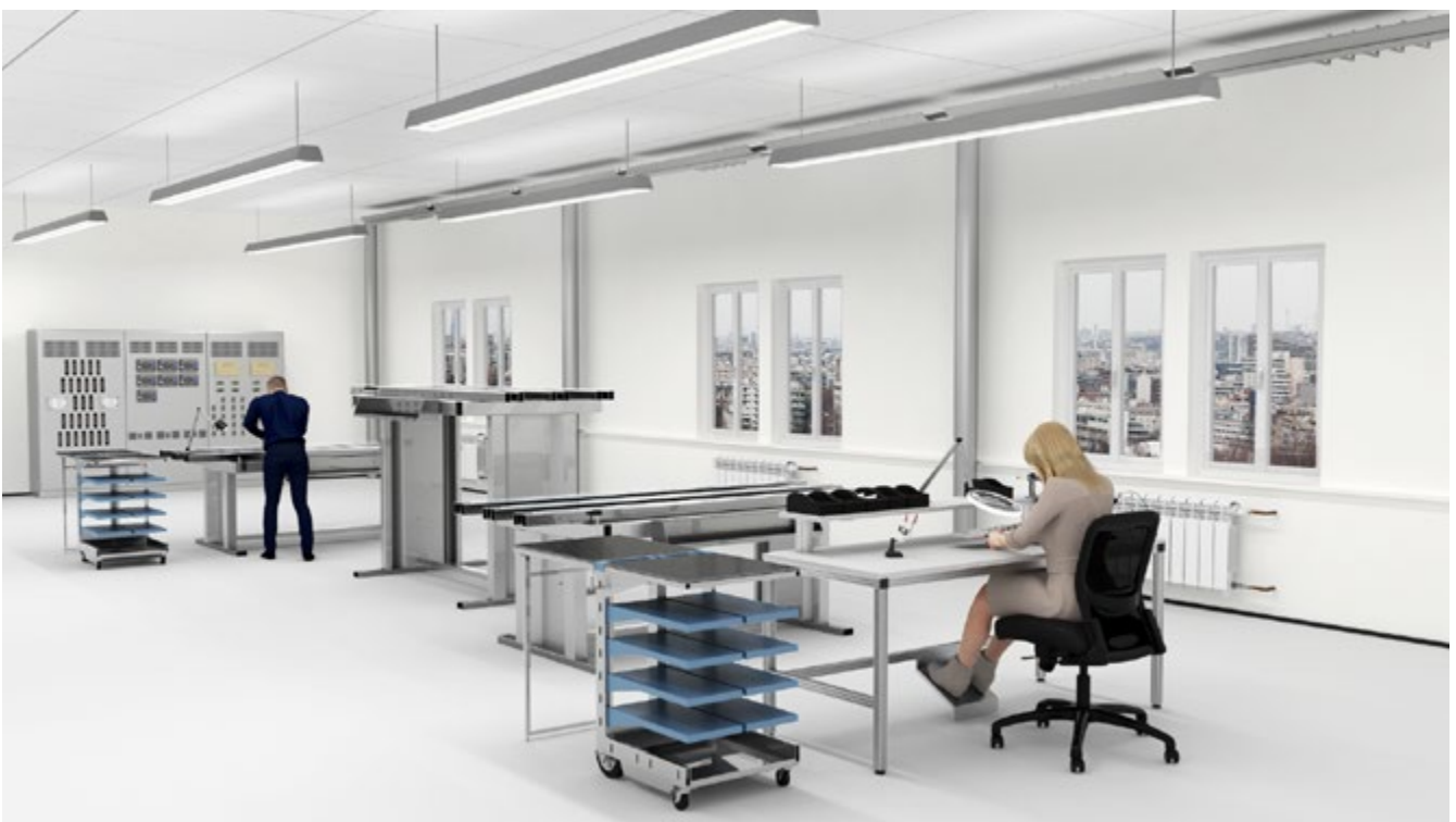
Abb. 16 Beispiel für eine auf den Bereich des Arbeitsplatzes bezogene Beleuchtung (500 lx) mit einer teilflächenbezogenen Beleuchtung (Arbeitsplatzleuchte) (zum Beispiel 750 lx)
